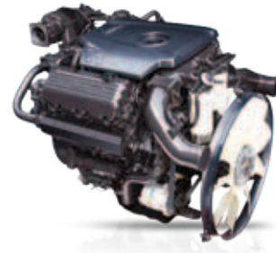
DV11 S - 最大输出功率 : 440 ps/ 1,900 rpm - 最大转矩 (Torque) : 205 kg·m / 1,200 rpm - 排气标准 : Euro-IV
