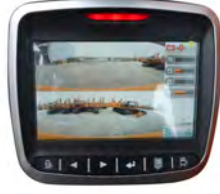
카메라 5대가 촬영한 영상을 컴퓨터로 조합해 실시간으로 보여줌으로써 360도 전방위 시야 확보 가능
