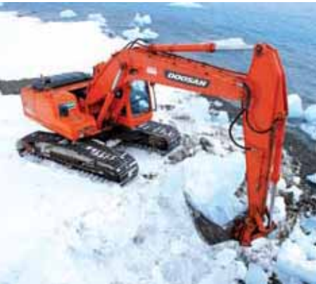
Doosan Infracore 挖掘机在南极世宗基地大显神威 在南极世宗基地使用的斗山挖掘机“Solar 220LC-V”是专门制造的，在零下 40 度的严寒中仍能照常作业。
